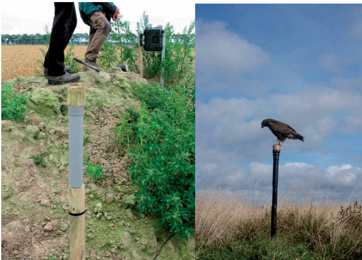
Figuur 3.4. Voorbeeld van een in een paal verwerkte digitale weegschaal. In het linker paneel is op de voorgrond de weegpaal te zien met op de achtergrond de eraan gekoppelde digitale camera. Het rechter paneel toont een buizerd die op de paal is gefotografeerd en gewogen. Beide foto's zijn genomen in de ontwikkelfase van de weegpalen en niet gedurende het experiment.
